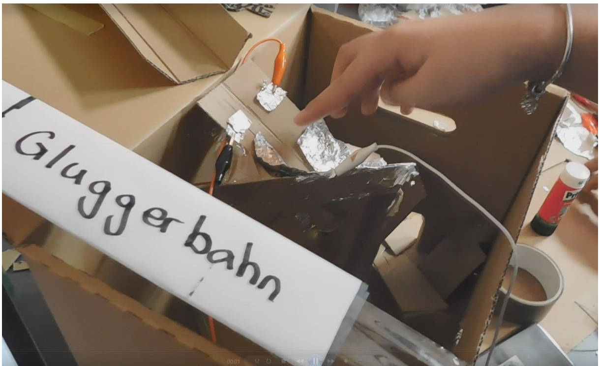
Analog-digitale Chügelibahn: die Kugel löst verschiedene Signale aus, die am PC verarbeitet werden.
