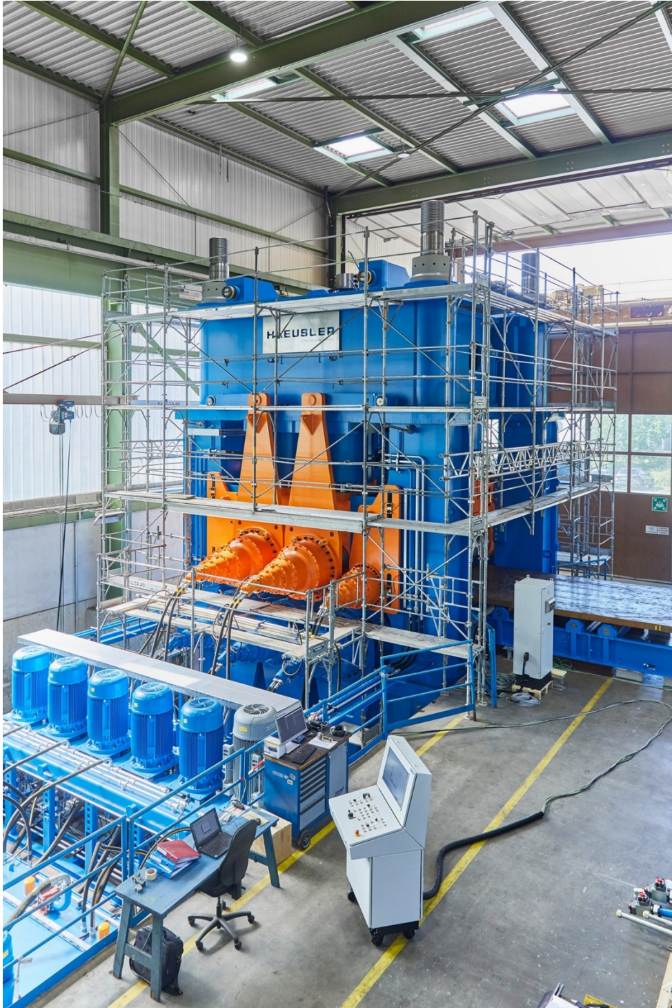
Bild der weltgrössten Richtmaschine, Haeusler AG Duggingen
